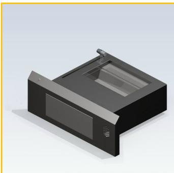
Der Fassadenschalter wird bei Apotheken und Pfortneranlagen eingesetzt, bei denen Gegenstände durchgegeben werden müssen. Das Gerät ist mit einem Schiebewagen ausgerüstet. Lichte Durchgabe: B-310 mm, H-64 mm, T-335 mm
