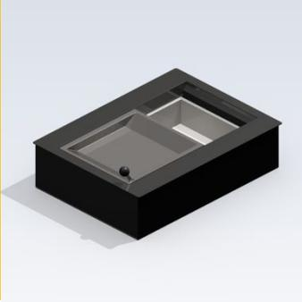
Diese Schiebezahlvorrichtung ist mit zwei gegenläufigen Zahlmulden ausgerüstet. Der obere Zahlwagen hat eine Durchgabehöhe von 28 mm, dies ist ausreichend für 2 Euro-Münzrollen, im unteren Zahlwagen können Tresordosen, Sparbüchsen, Geldsäcke etc. bis 90 mm Höhe durchgegeben werden.
